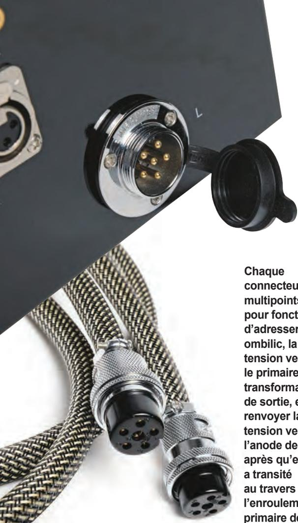
**Chaque connecteur multipoints a pour fonction d'adresser, via un ombilic, la haute tension vers le primaire du transformateur de sortie, et de renvoyer la haute tension vers l'anode de la 845 après qu'elle a transité au travers de l'enroulement primaire de ce transformateur. Un condensateur de filtrage haute tension est placé à l'entrée du primaire du transformateur.**
