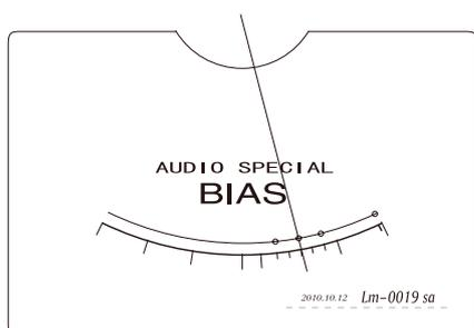
L'ajustement du courant doit être le même pour les 2 tubes afin d'obtenir un rendu sonore optimal de l'amplificateur.
