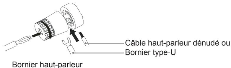
Veillez à ce qu'aucun brin non isolé ne puisse court-circuiter les sorties des enceintes. Veillez à ce que les bornes des enceintes soient suffisamment serrées pour assurer un bon raccordement électrique. Si les bornes à vis ne sont pas assez serrées, la qualité sonore peut être affectée.
